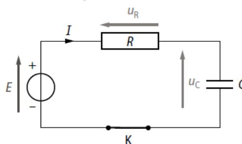
2. a. À l'instant initial, le condensateur est déchargé. La tension à ses bornes est nulle.
